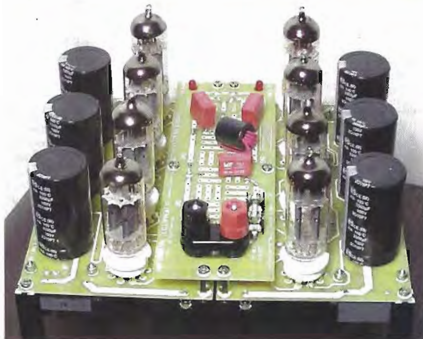
fig.7 - Vista d'insieme del c.s. del filtro EMI avvitato sopra i c.s. del ponte. Il filtro qui fotografato è una versione precedente rispetto a quello di fig.5
